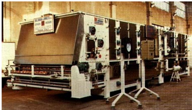
Figure 10 - Photo d'un pasteurisateur industriel en bouteille
